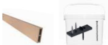
DIELENVERBINDER UND SCHRAUBEN FÜR BODENDIELE 140 X 20 MM: Die Dielenverbinder werden auf die Unterseite der Dielen geschraubt, unter die vorherige Diele geschoben und an der gegenüberliegenden Seite der Unterkonstruktion befestigt.
